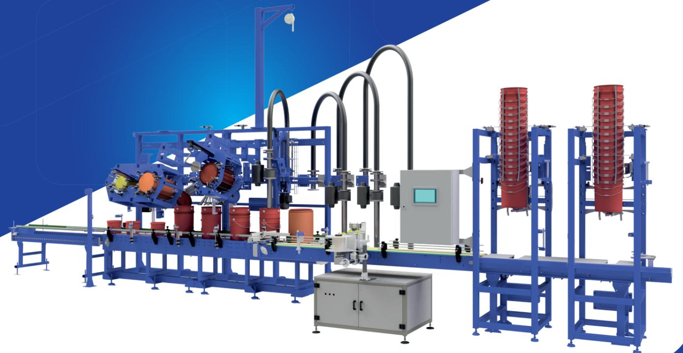
Автоматическая станция фасовки жидких материалов в тару объемом от 5 до 50 л, такую как металлические ведра, пластиковые ведра, картонно-набивные барабаны.
