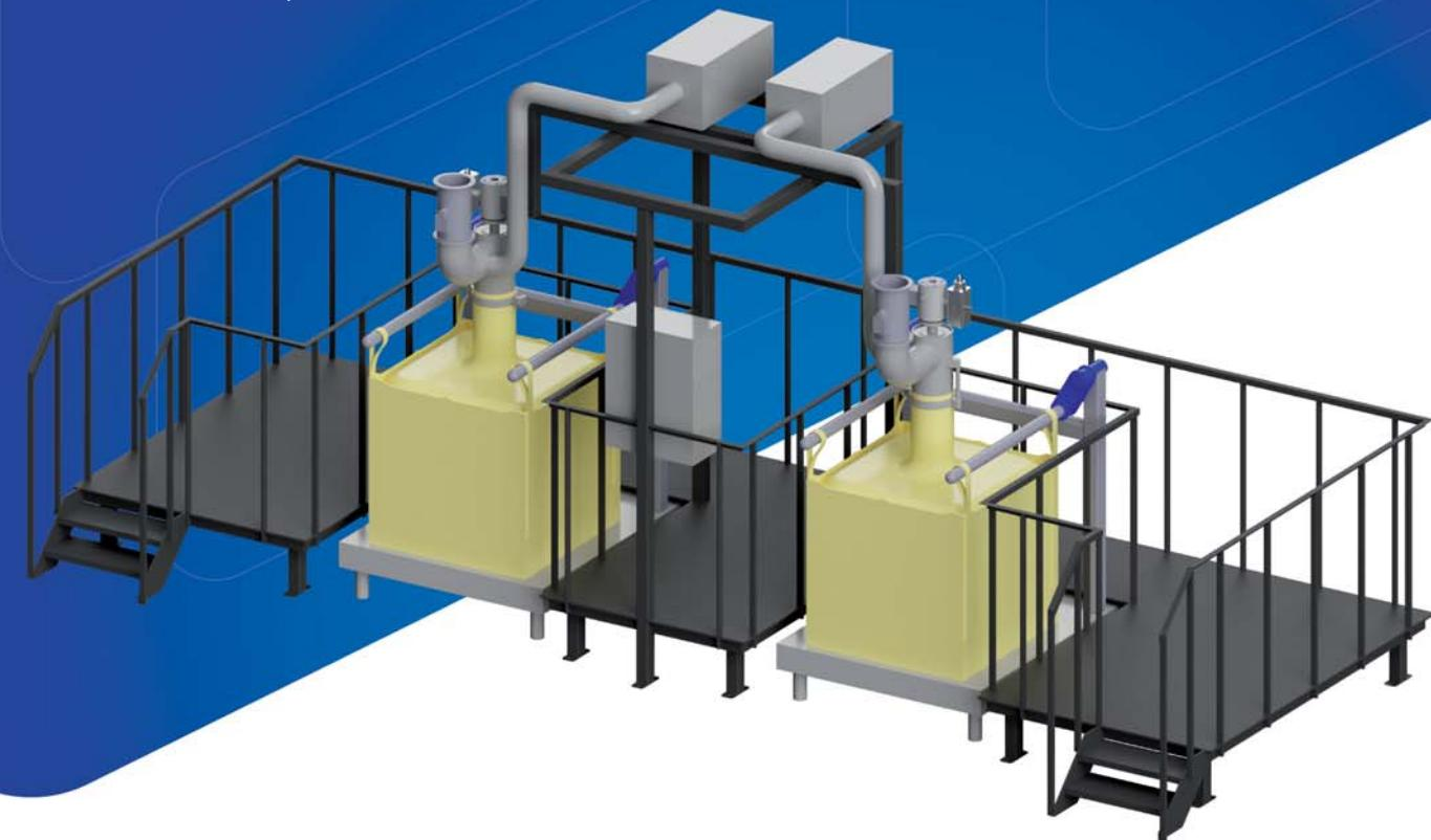
Автоматические установки фасовки битума требуют применения тары с открытым верхом, например, кловертайнеры, бочки 200 л. Перемещение тары вдоль транспортной линии и наполнение производятся автоматически. Требуется только устанавливать пустые и снимать заполненные поддоны с тарой с транспортной линии.
